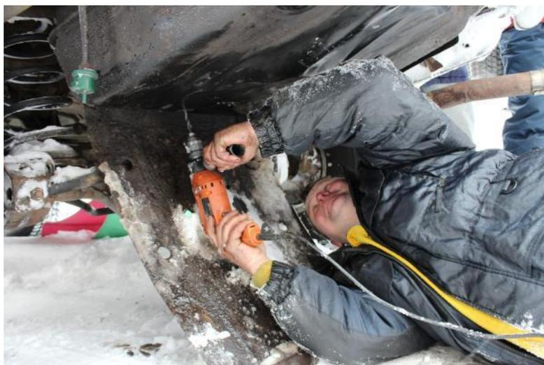
11. Расширили отверстие под болт.
