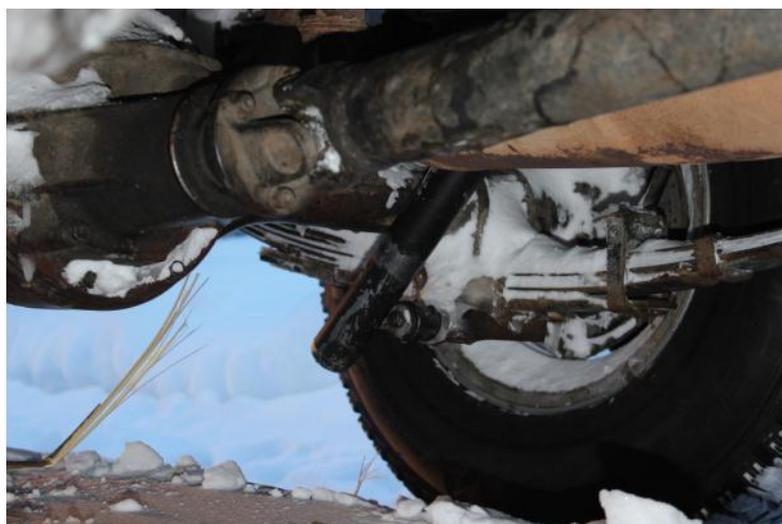
7. На очередной кочке оторвали левый амортизатор у 11-го экипажа
