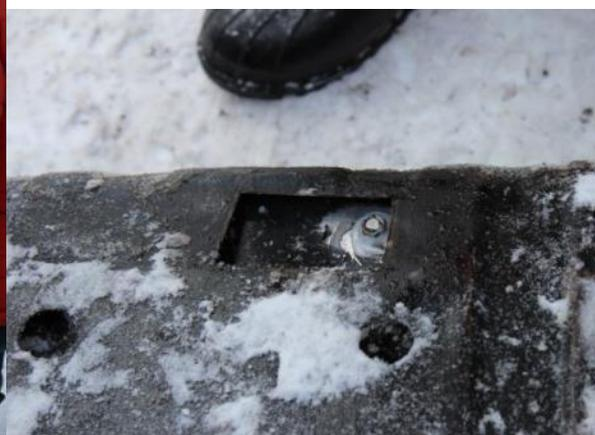
12. В отверстие вставили болт + залили герметиком. Т.к. конец болта упирался в защиту, пришлось на защите вырезать отверстие под выступающий болт.
