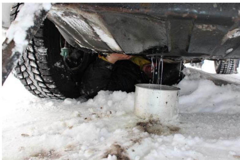
10. Пробитый бак. От удара вырвало клёпку уравнивателя топлива, образовалось отверстие 6 мм и вылилось около 20л. дизельного топлива.
