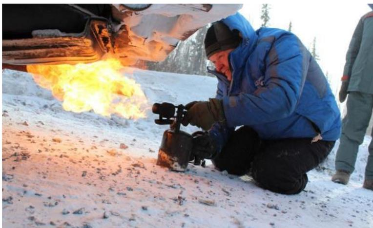
25. Где-то перемерз топливопровод. Для ремонта использовалась паяльная лампа.
